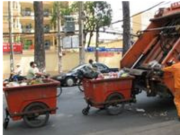
Hình 5.1: Xe thu gom rác thải đang thu gom chất thải rắn sinh hoạt từ các xe thu gom cỡ nhỏ
